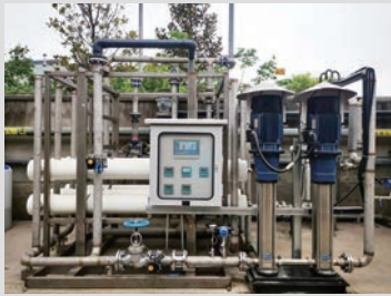
苏州某企业SW (海水淡化) 膜系统(300m3/d)
